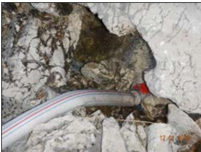
Slika 3.3: Provjera upojnosti mikrolokacije na makadamskom putu, površine 10x3 m
