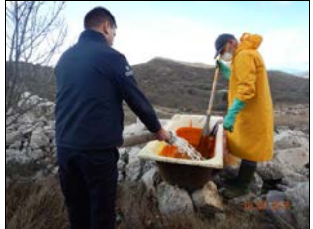
Slika 3.9: Ispiranje trasera po izvršenom upuštanju u podzemlje
