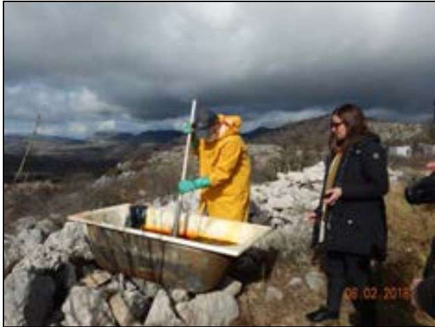
Slika 3.8: Priprema i upuštanje trasera Na-fluoresceina na lokaciji Osojnik
